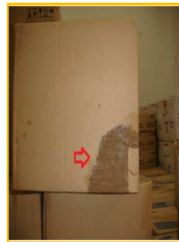
5、包装湿水 \geq 80 \times 60\text{mm}
